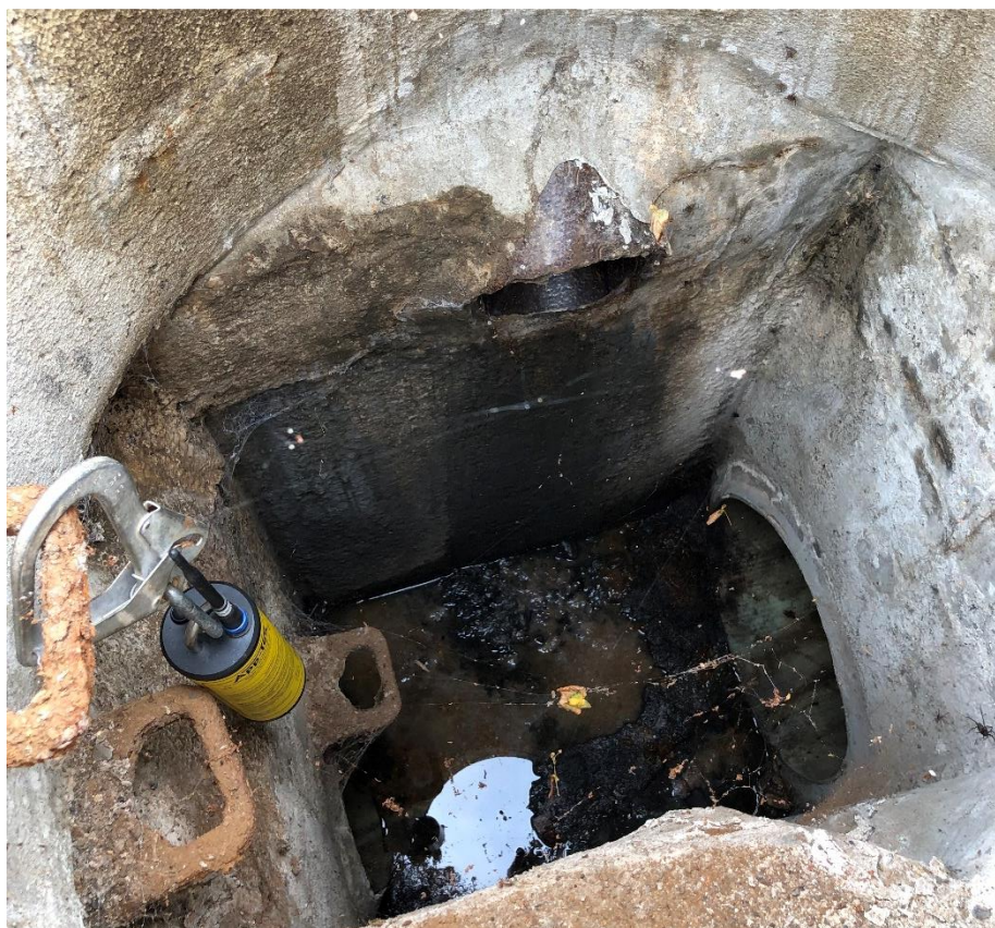
Obr. 5 – Měření H 2 S provedené v šachtě u zastávky MHD Škola
